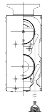
Abb.27 Schnitt B-B durch eine modulare, automatische Rauchschürze mcr PROSMOKE ONE V mit Modulen übereinander in einem Gehäuse angeordnet
